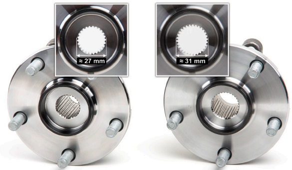
Kuva 2: Puoliakselien kiinnityshalkaisija on erilainen
