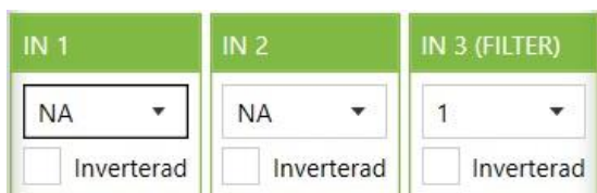
Kuva 55 – Laiteohjelmiston versioissa 4.0.4–4.0.9 suodattimet on sisäänrakennettu tulosignaalin valintaan 3.
